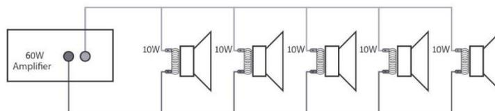
Sustav zvučnika od 100 V može se sastojati od mnogo zvučnika povezanih zajedno. Odlučujući faktor za to koliko se zvučnika može koristiti na jednom pojačalu je ukupna snaga pojačala. U većinu slučajeva savjetuje se povezivanje onoliko zvučnika koliko je potrebno s kombiniranom snagom ne većom od 90% izlazne snage pojačala.
